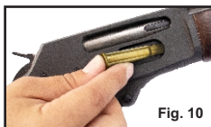
Arma de fuego siendo cargada a través de la puerta de carga
