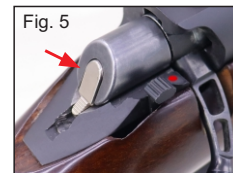
Indicateur d'armement en position "tiré"
